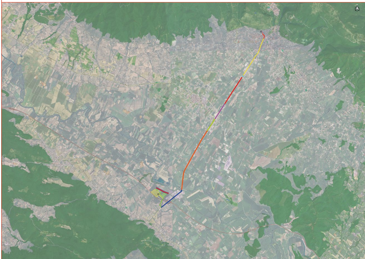
◆ FIGURA 6 Inquadramento territoriale dell'impianto fotovoltaico di Dragoni con sistema di connessione alla cabina primaria AT/MT di Piedimonte Matese (CE) (Elab. Autori)
