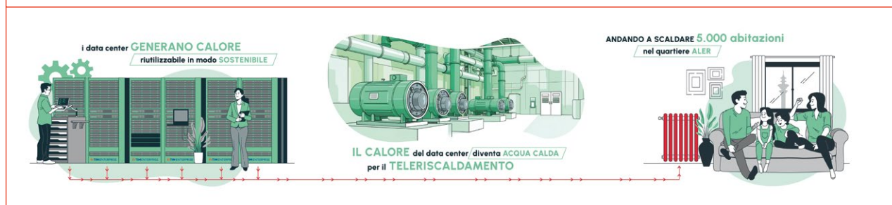
◆ FIGURA 4 Schema di processo del recupero termico dal Data Center al teleriscaldamento urbano
