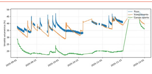
◆ FIGURA 23 Umidità al suolo (%) nelle sezioni fisso, tracker e campo aperto, a -40cm, da Settembre a Novembre 2025
