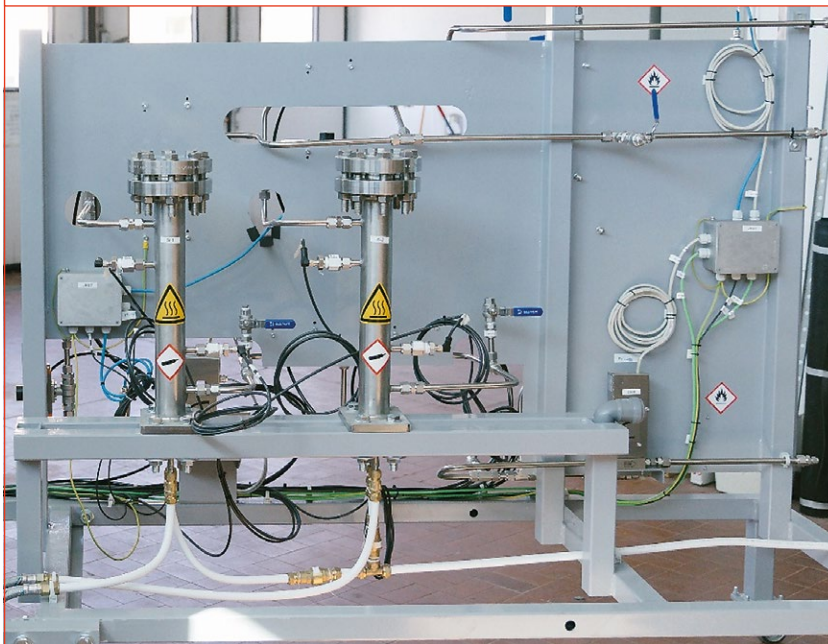
◆ FIGURA 2 Vista frontale delle colonne adsorbenti dell'impianto pilota T-H2SAM®, parte del sistema di purificazione dell'idrogeno da syngas
